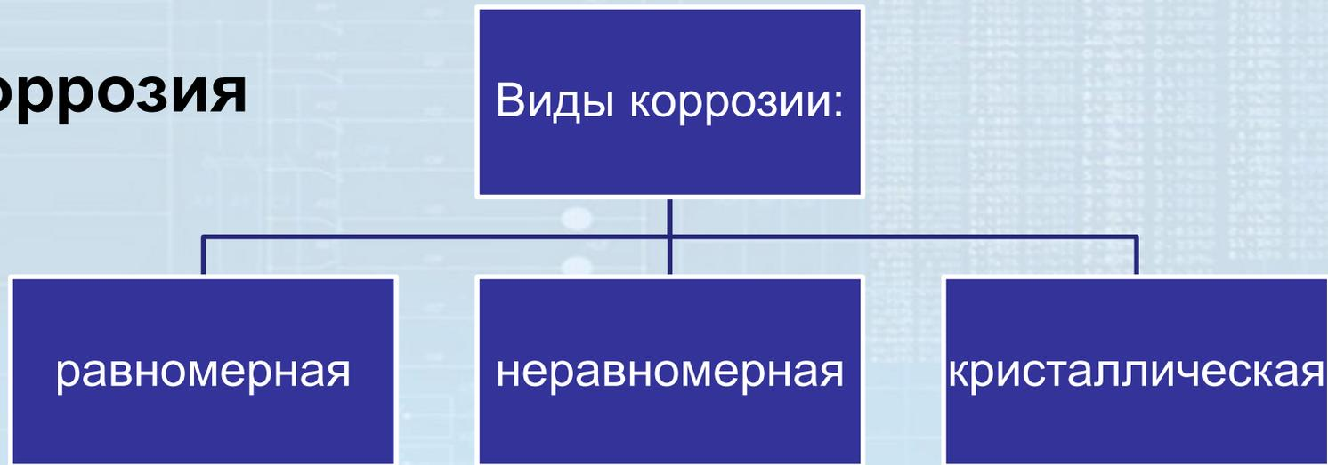
При **равномерной** коррозии процесс распространяется постепенно от отдельных корродирующих мест по всей поверхности металла.
