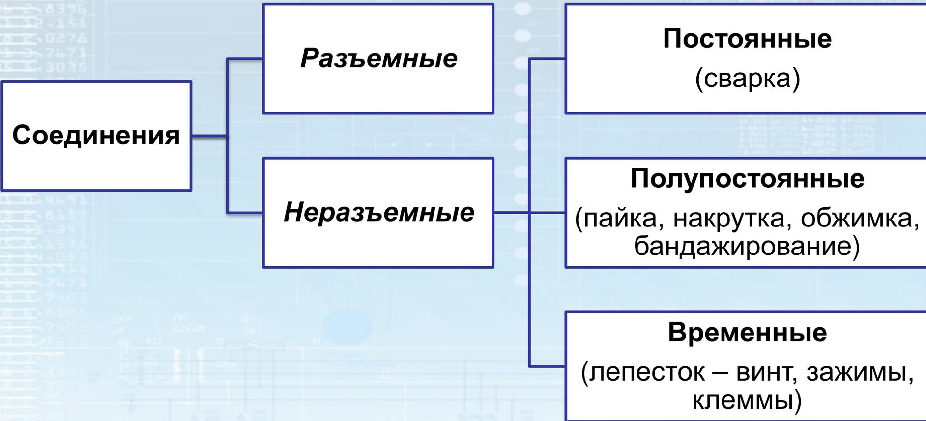
*Способ электромонтажа и его элементы выбирают с учетом назначения ВТ, конструктивно-технологических и эксплуатационных требований.*
